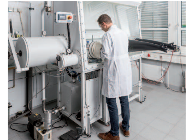
Neue elektrochemische Prozesse zur Abscheidung von Lithiummetall für Batterieanoden in Schutzatmosphäre.
