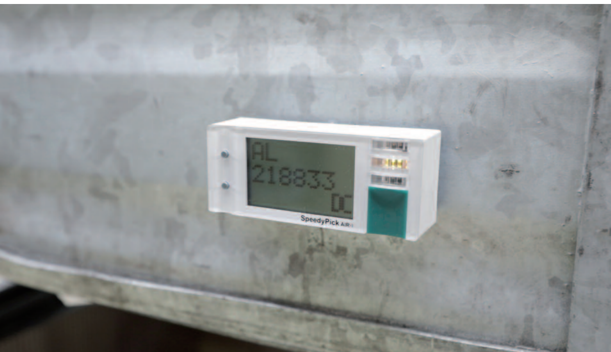
Mit einer gelben Lichtmarkierung zeigt das Pick-by-Light-System dem Werker an, welche Teile montiert werden müssen.
