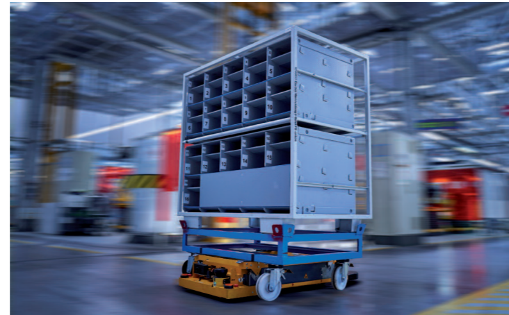
»Smart Transport Robots STR« bei BMW nutzen eine Navigationssoftware vom Fraunhofer IPA mit ROS-Komponenten. (Quelle: BMW Group)
