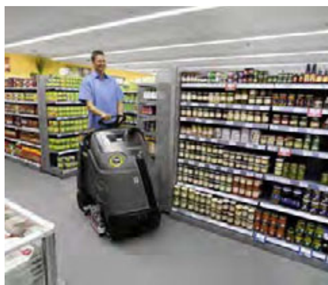
Abb. 3-5.1 Typisches Beispiel einer Bodenreinigung im Supermarkt, hier der Kärcher BD 60/95 RS.
