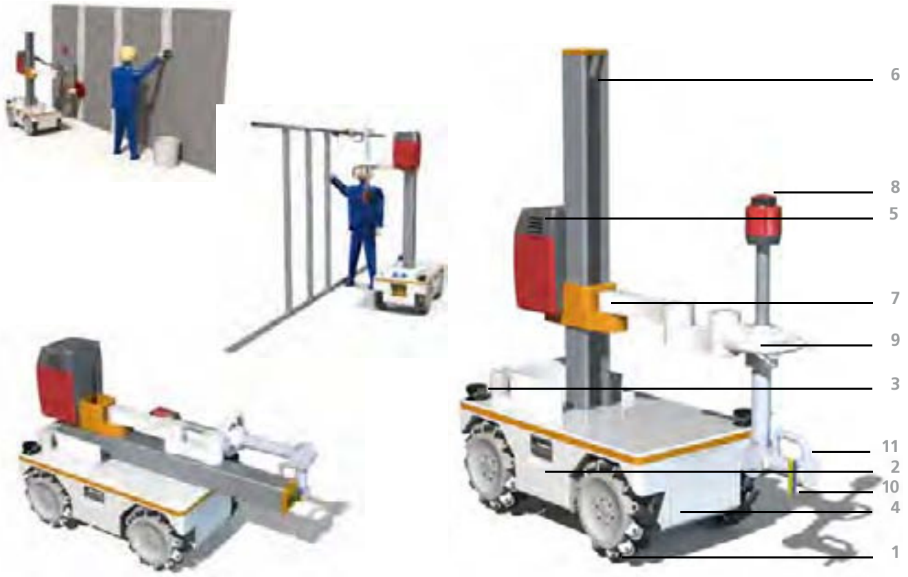
Abb. 3-8.5 Entwurf des Serviceroboters für den Innenausbau mit der SR-Variante A
