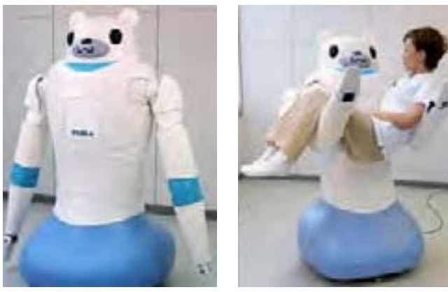
Abb. 3-3.5 Prototyp RIBA bei der Personenaufnahme. Quelle: RIKEN-TRI Collaboration Center for Human-Interactive Robot Research
