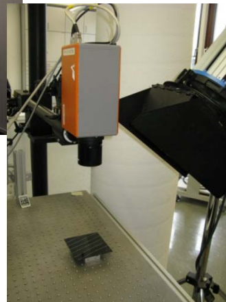
Thermographiesystem rechts mit Velox 65kM und oben mit CMT 384 M/SM
