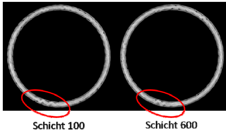
CT Rohr: Schnittbilder mit sichtbarer Lageverschiebung/Wellenbildung
