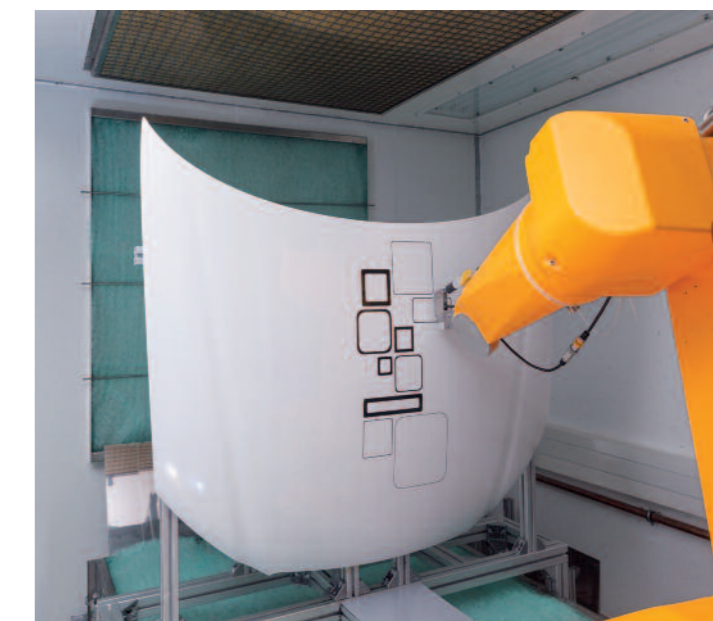
Einer der drei untersuchten Ansätze zur oversprayfreien Beschichtung am Beispiel der selektiven Beschichtung einer Motorhaube (Quelle: Fraunhofer IPA).
