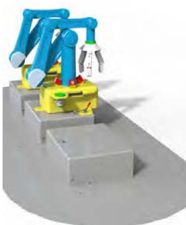
Abb. 3-11.5 links: Zwei Produktionsassistent-Serviceroboter auf der Ladestation am Mäanderanfang; rechts oben: Serviceroboter bei der Lenkradmontage im Kfz; rechts unten: Serviceroboter zur Innenraummontage im Kfz.
