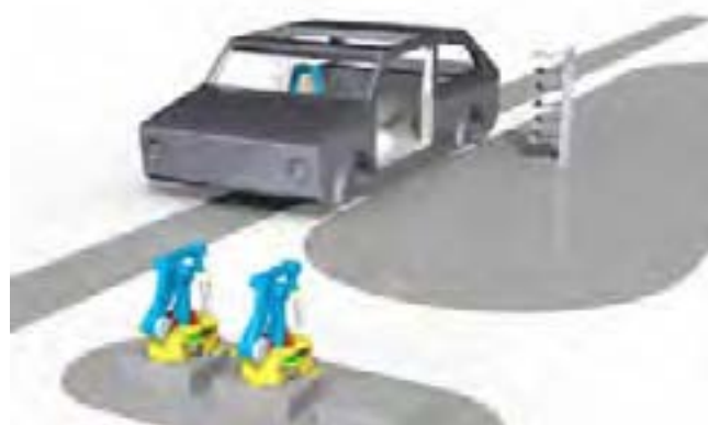
Abb. 3-11.5 links: Zwei Produktionsassistent-Serviceroboter auf der Ladestation am Mäanderanfang; rechts oben: Serviceroboter bei der Lenkradmontage im Kfz; rechts unten: Serviceroboter zur Innenraummontage im Kfz.
