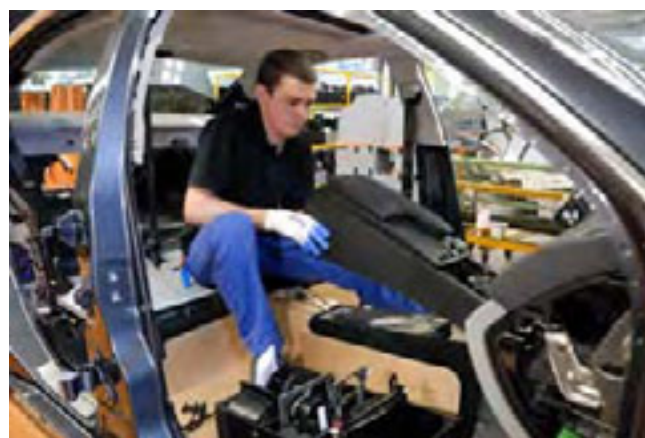
Abb. 3-11.1 Innenmontage am Fließband
