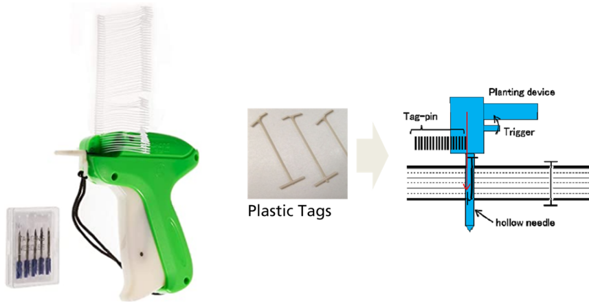
Abbildung 20: Tagging Gun und schematische Funktionsweise ©rechtes Bild: Hatakenaka et al.
