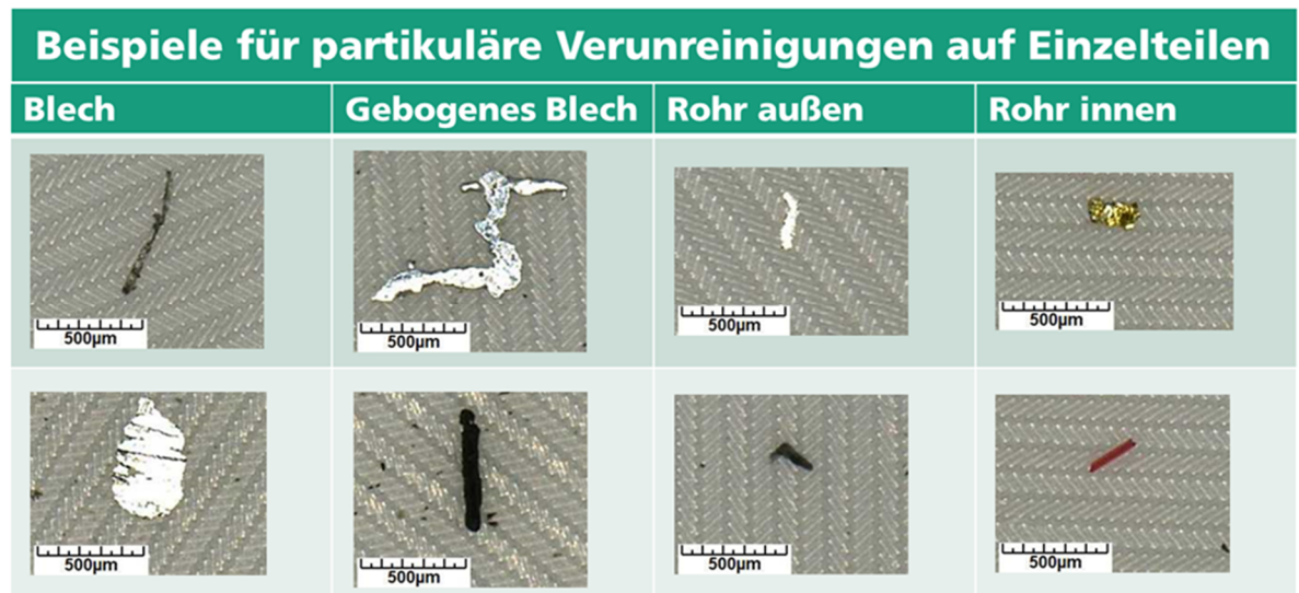
Abbildung 3: Ergebnisse der Sauberkeitsanalysen: Beispiele für partikuläre Verunreinigungen
