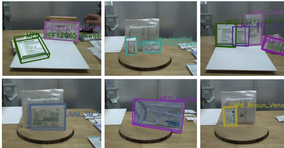
Abbildung 9: Evaluation der Objekterkennung anhand von medizinischen Testobjekten.
