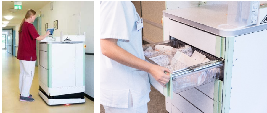
Abbildung 7: Intelligenter Pflégewagen mit 3 Schubladen für den Wäschetransport (Einsatz in den beteiligten Altenpflegeeinrichtungen, links) und mit 5 Schubladen für den Transport von Verbandsmaterialien (Einsatz in der Klinik, rechts)
