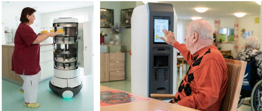
Abbildung 11: Einfaches Befüllen des robotischen ServiceAssistenten mithilfe der Tablett (links), Touchscreen zur Auswahl eines Getränks (rechts).
