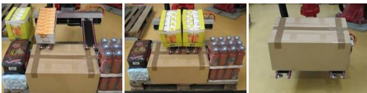
Abbildung 7: Greifmöglichkeiten des Demonstrator 1
