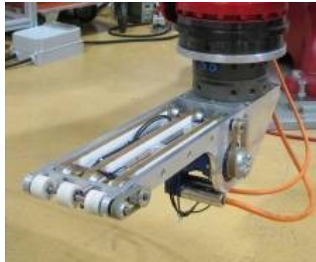
Abbildung 2: Aufwalzmodul im CAD (links) und am Roboter in den Versuchsfeldern des Fraunhofer IPA (rechts)
