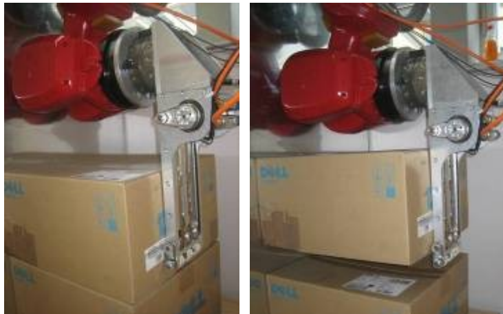
Abbildung 19: Versuche mit dem Aufwälz-Kipp-Prinzip
