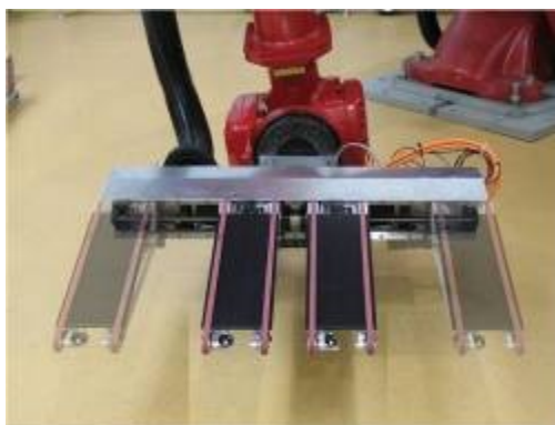
Abbildung 6: Demonstrator 1, Aufwälzmodule kombiniert mit Großhub-Greifer
