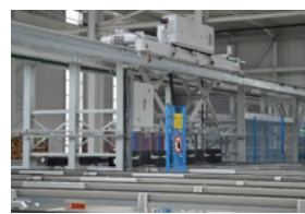
Manipulator zum Transport von Materialbündeln zum Ladeplatz
