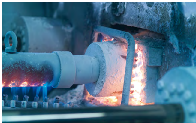
Gasbetriebener Magnesiumdruckgussprozess: Ansatzpunkt für eine bivalente Energieversorgung. (Quelle: C&C Bark)
