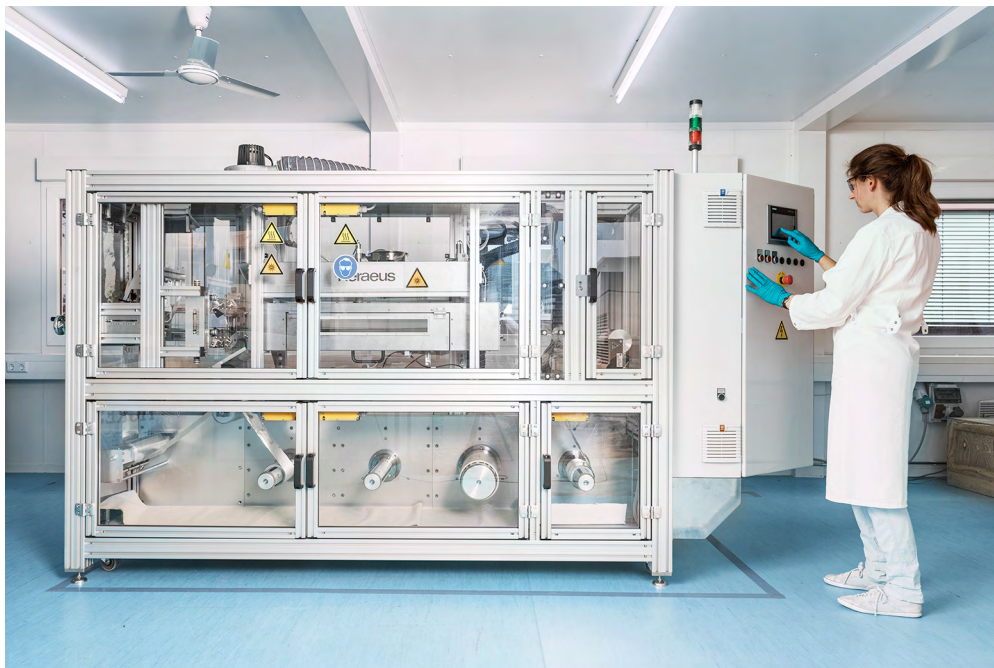
Rolle-zu-Rolle-Beschichtungsanlage der Modellfabrik (Quelle: Fraunhofer IPA, Foto: Rainer Bez)
