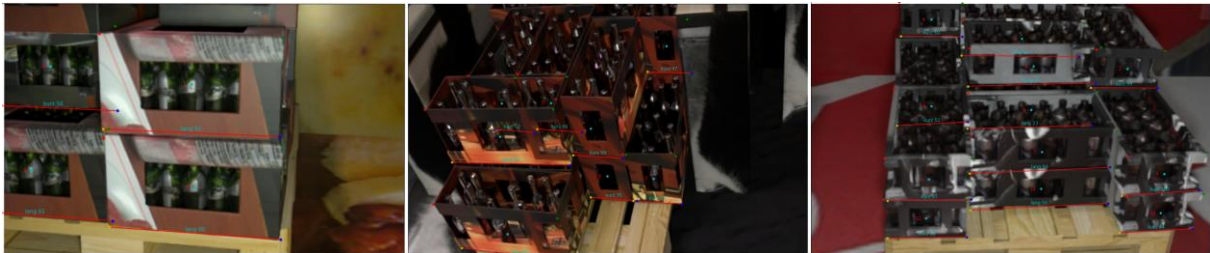
Abbildung 4: Detektion von Kisten/Flaschengebinden in synthetischen Daten, wie sie auch für das Training des CNNs verwendet wurden: untere Kante der Kisten (rot), Klassifizierung lange/kurze Seite und geschätzte Sichtbarkeit (cyan)
