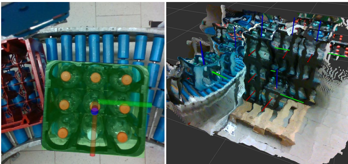
Abbildung 5: CNN-basierte Kistenerkennung auf Paletten und Rollbahn (ENS); typische Ergebnisse für Kisten mit Sichtbarkeit größer 80%. Das eingezeichnete Koordinatensystem mit roter, grüner und blauer Achse markiert den Mittelpunkt der Kiste und die Orientierung im Raum.
