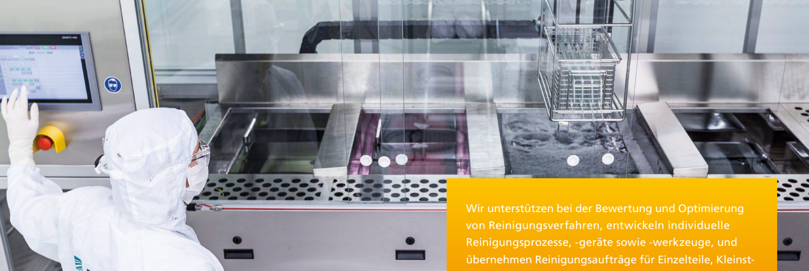
Feinreinigungsanlage mit Ultraschalltauchbecken im Reinraum der Klasse 1 (nach ISO 14644-1).
