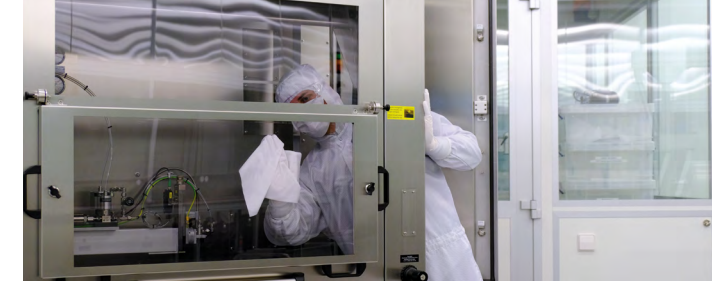
Wischreinigung der zugänglichen Oberflächen einer CO 2 -Reinigungsanlage.
