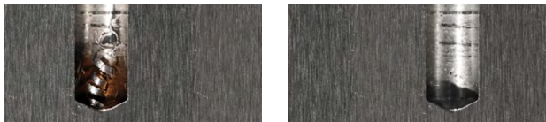
Bearbeitungsrückstände im Bohrloch (Span, Öl)
