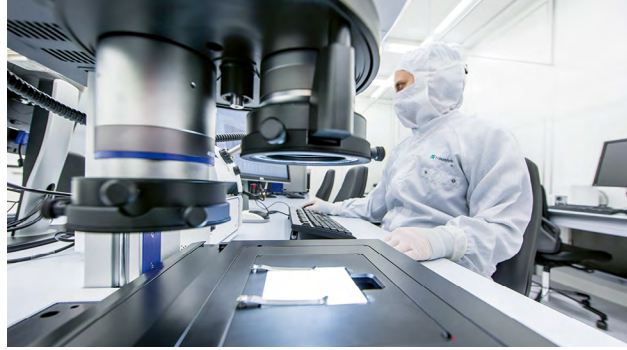
Reinheitsvalidierung zur Überprüfung der geforderten Bauteilsauberkeit
