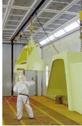
Lackieranlage für große Maschinenteile
